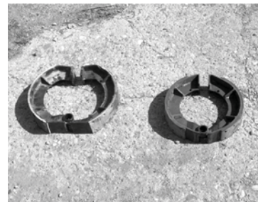
Fig. 5 Two brakes' dimensions, 300 \times 80 și \text{Ø} 250 \times 60
