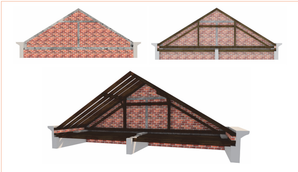
Slika 24. Stabilizacija izvedbom jedne UG (greda okomita na zabat) za zidove H < 5,0 m, slike redom: pogled izvana, pogled iznutra, perspektiva iznutra
