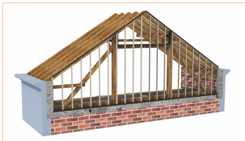
Slika 37. Izvedba zabata konstrukcijom od tankostijenih čeličnih profila
