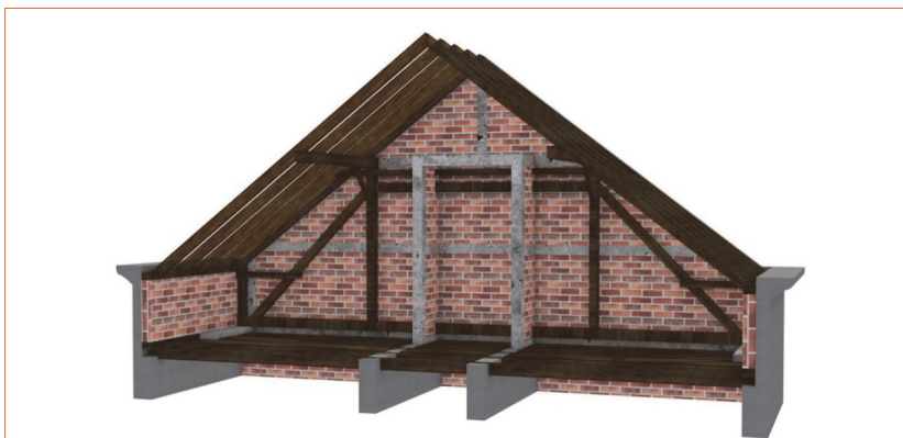
Slika 34. Stabilizacija peterokutne lastavice većih raspona izvedbom zidanih kontrafora
