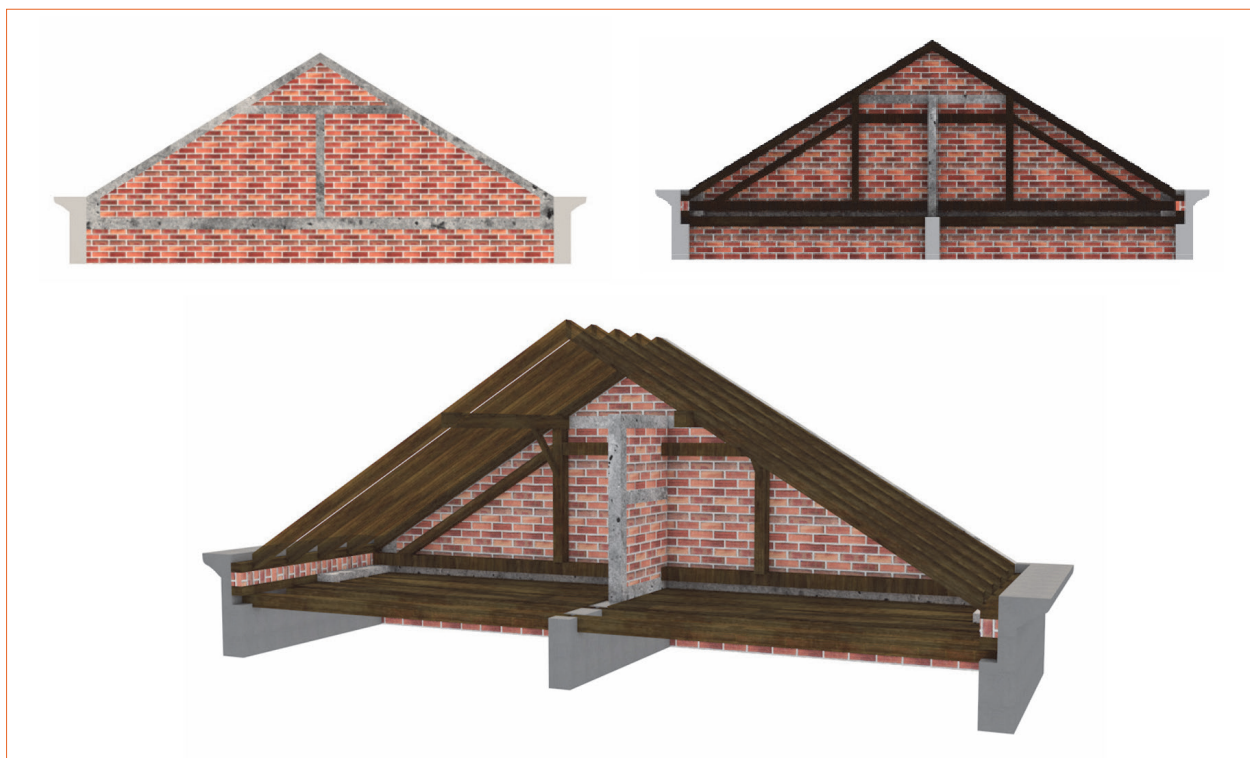
Slika 22. Stabilizacija jednom kontraforom za zidove visine H > 5,0 m, slike redom: pogled izvana, pogled iznutra, perspektiva iznutra
