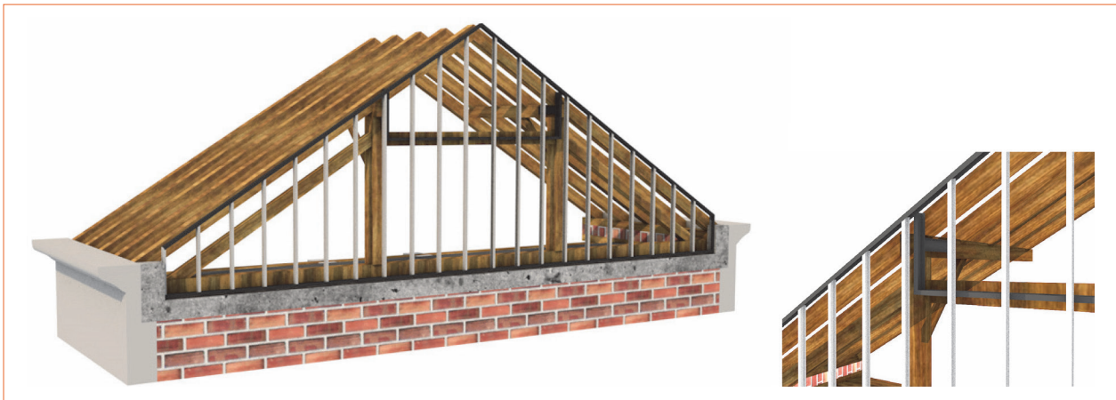
Slika 36. Izvedba zabata konstrukcijom od standardnih čeličnih profila
