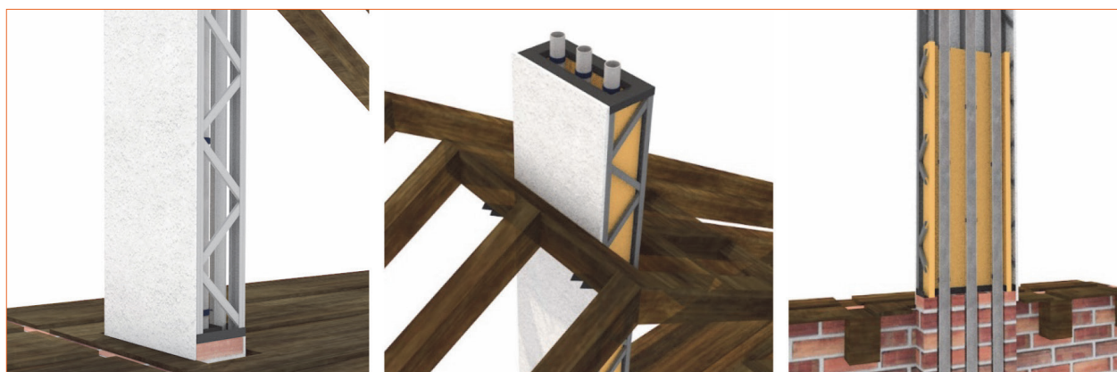
Slika 13. Prikaz izvedbe konstrukcije dimnjaka tankostijenim profilima – izvedba obloge
