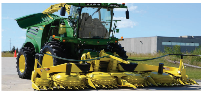
Slika 72. Krmni kombajn opremljen hederom s rotirajuće nazubljenim zubicima
