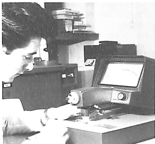
Mjerenje gustoće zacrncjenja na denzilometru u laboratoriju za fotografske procese
