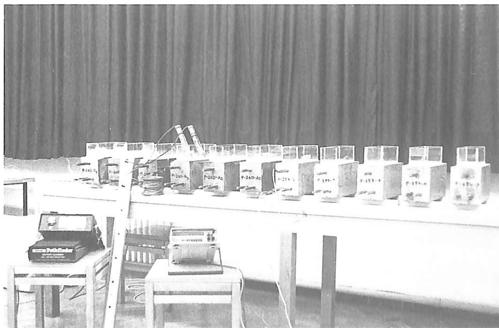
Ispitivanje efikasnosti inhibitora korozije armature ugrađene u beton
