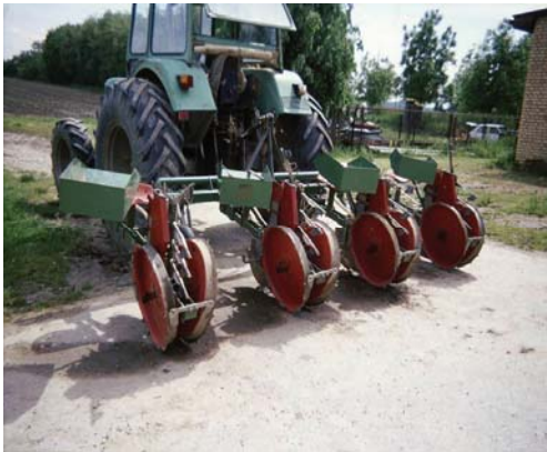
Slika 90. Poluautomatska sadilica duhana
