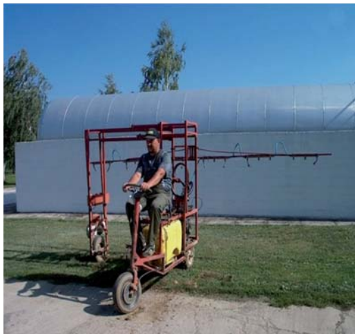
Slika 101. Stroj za prskanje duhana u pokusima
