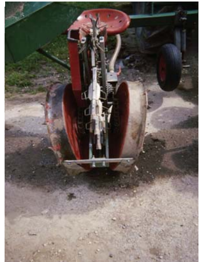
Slika 91. Izdvojena jedinica sadilice s hvataljkom
