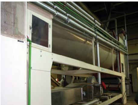
Slika 125. Cilindar za navlaživanje duhana
