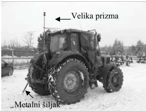
Sl. 1 Traktor sa postavljenom velikom prizmom i metalnim šiljakom
