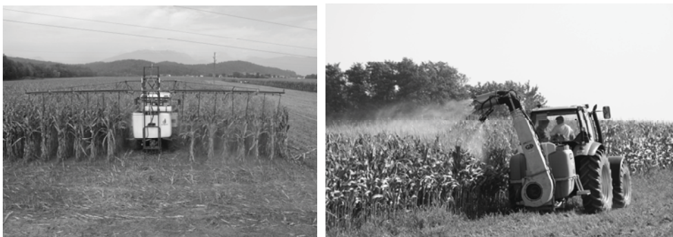
Slika 1 Prskalica sa visoko namještenom armaturom i cijevnim produžecima te raspršivač s topom za raspršivanje
