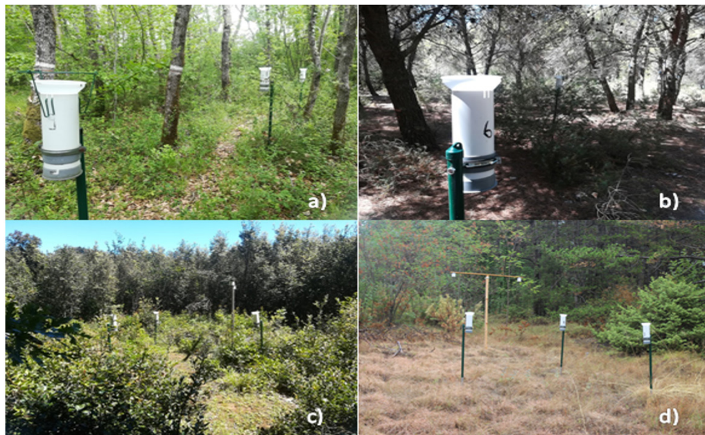
Slika 1. Kolektori za prikupljanje atmosferskog taloženja u šumi a) hrast medunac, b) alepski bor i izvan šume c) hrast crnika i d) crni bor
