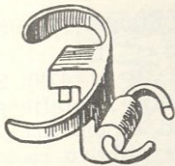
Sl. 476. Šarnirska zglobna veza po Gottliebu
