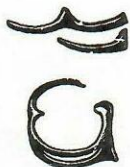
Sl. 500. Kalupi za oblikovanje voštanih elemenata kostura po Neyevu sustavu; kalupi za razne vrste kvačica i za prekočeljusne lukove (iz brošure »Das Ney-System«)
