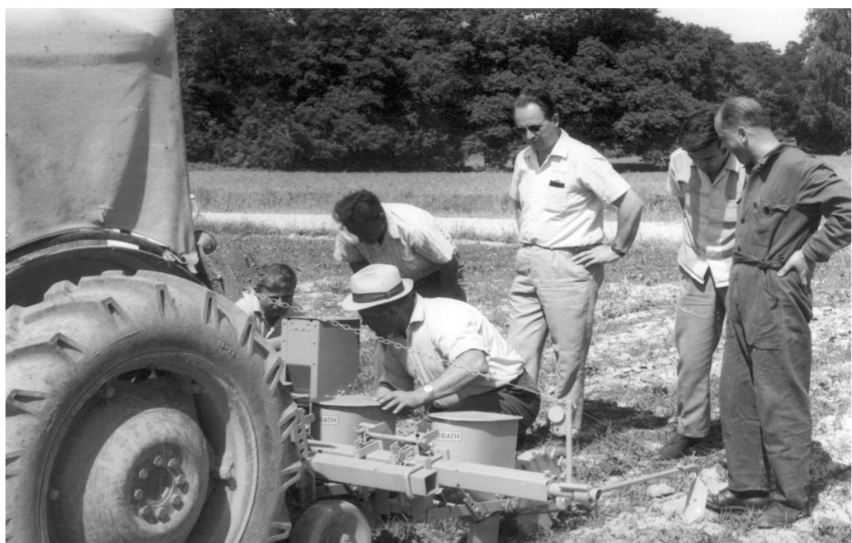
Slika 23. Provjera kvalitete rada mehaničke sijačice za okopavine 1960.-1970.
