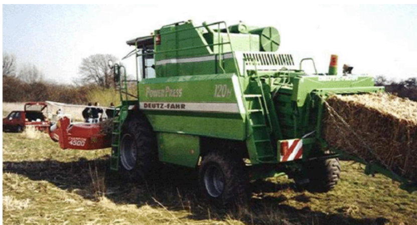
Slika 54. Samokretni krmni kombajn s prešom ( www.biowatt.hu )
