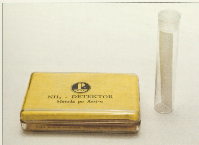
Slika 1.1. Detektor za određivanje amonijaka metodom prema Asaju Picture 1.1. Ammonium detector via method according to Asaj
