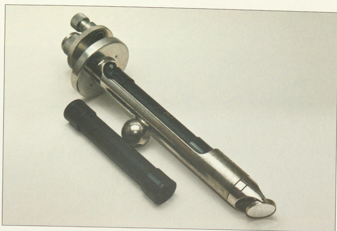
Slika 1.6. Saharometar, polusjenski prema Zeisu za određivanje šećera u otopini Picture 1.6. Saccharometer according to Zeiss for determination of sugar in solutions
