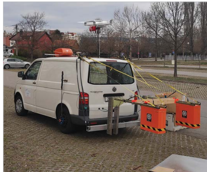
GPR uređaj za određivanje debljine slojeva kolničke konstrukcije
