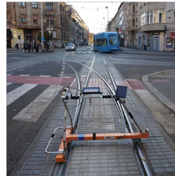
Digitalna kolica za mjerenje geometrije kolosijeka
