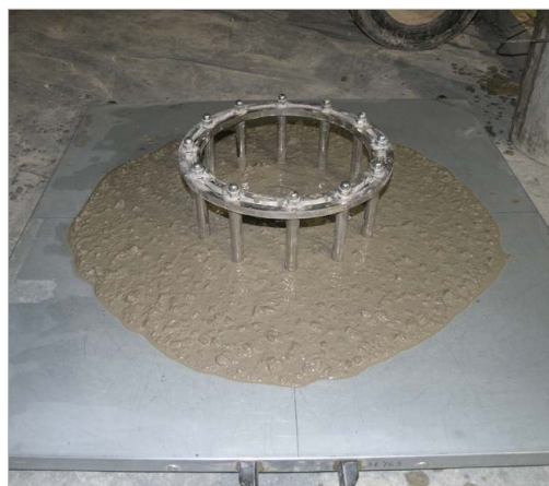
— Ispitivanje svojstava samozbijajućega betona u svježemu stanju
