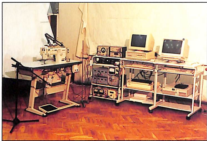
Sustav za automatska mjerenja procesnih parametara i struktura tehnoloških operacija proizvodnje odjeće (patent br. P2000062 ADZIV)
