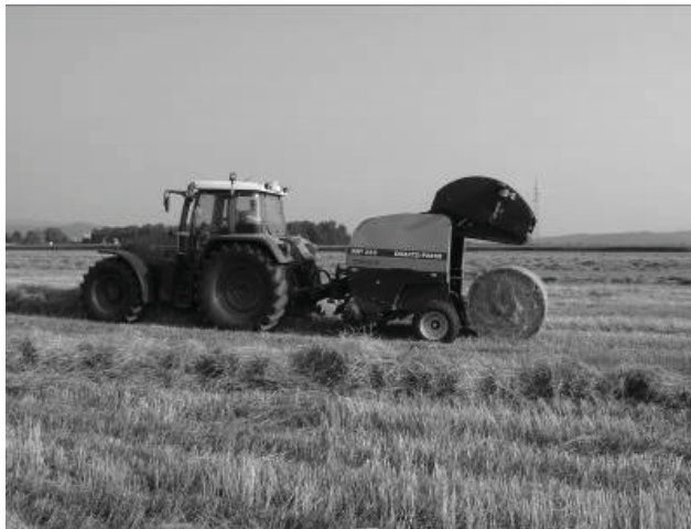
Slika 1. Za pobiranje slame in koruznice in stiskanje oziroma izdelavo suhih bal za zmanjševanje prostornine žetvenih ostankov za energetske namene se lahko uporabljajo obstoječe stiskalnice za valjaste bale, ki so razširjene v slovenskem kmetijskem prostoru
