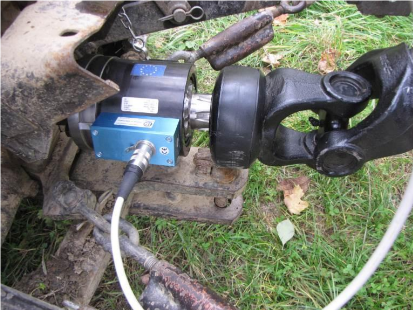
Slika 2 Dinamometar (Lorenz Messtechnik DR 2472 5000 Nm) za mjerenje momenta i broja okretaja.
