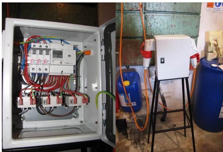
Slika 1 Prenosni merilnik porabe električne energije, ki se povezuje s posameznimi stroji ali s celotno električno instalacijo v hlevu; merilnik beleži trenutno, maksimalno, kumulativno itn. porabo električne energije priključenih strojev
