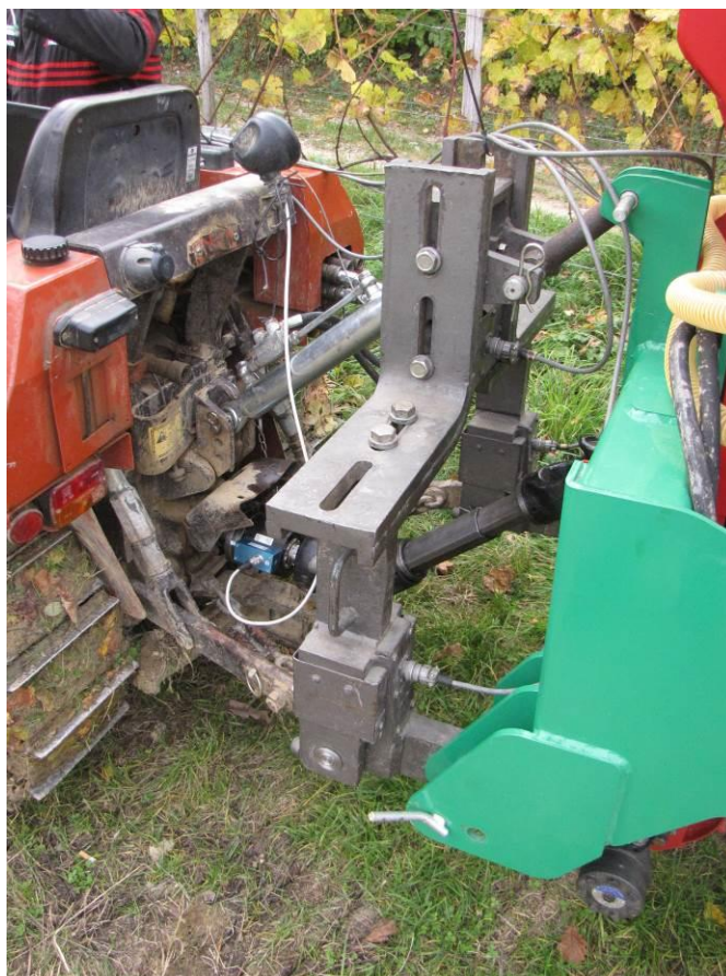
Slika 3 Dinamometarski tro-zglobni okvir za mjerenje vučne sile odnosno njenih uzdužnih komponente.
