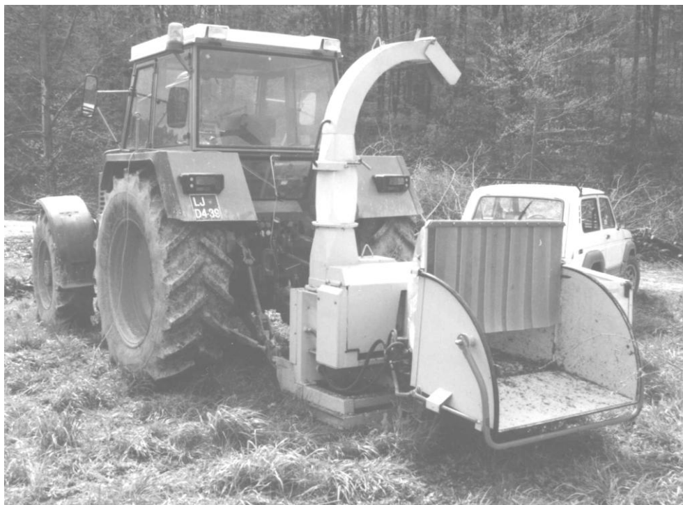
Slika 1: Sitnilica Chromcom Lignatec Z190 nošene je izvedbe, a pogon ima preko priključnog vratila traktora
