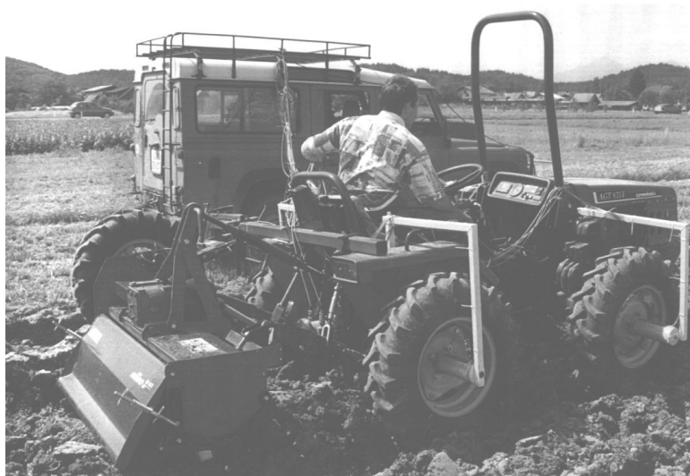
Slika 4. Mjerenje na traktoru agregatiranom sa rovilicom (frezom)
