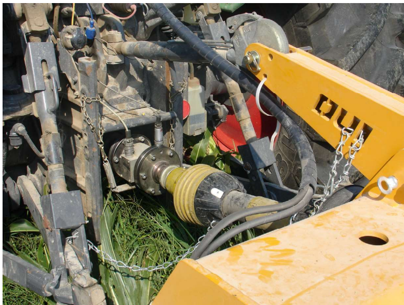
Slika 1 Dinamometar za mjerenje momenta i broja okretaja (T 30 FN Hottinger Baldwin Messtechnik) na priključnom vratilu traktora
