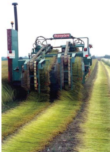
Slika 33. Mehanizirana berba predivog lana strojevima čupačima
