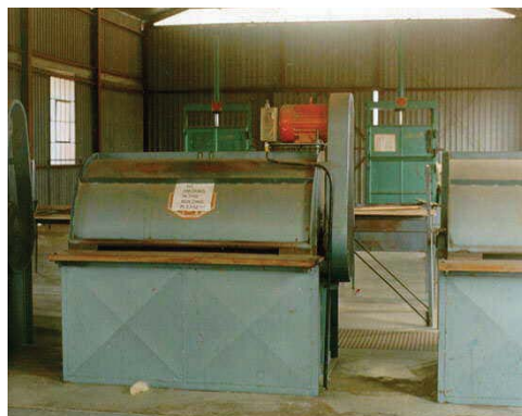
Slika 86 Strojevi za skidanje površinskog sloja listova sisala
