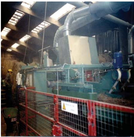
Slika 40. Turbina za odvajanje sjemena od stabljike
