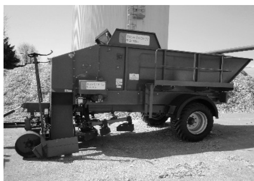
Slika 2 Specijalna automatska sadilica (izvor: www.newenergifarms.com )
