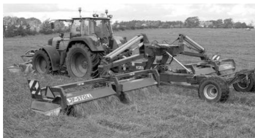
Sl. 6 Kombinacija vučene kosilice JF-STOLL – GXT 12005 SM Collector i prednje nošene kosilice GFX, radni zahvata je 11,55 m
