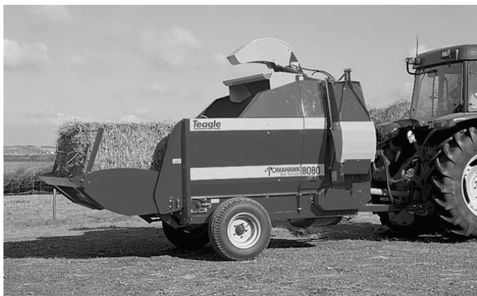
Slika 6 Usitnjivač četvrtastih bala (www.trejon.se)
