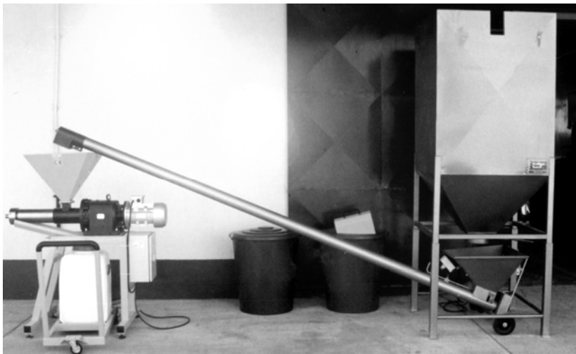
Slika 1 Primer mikro oljarne (Hocem) za proizvodnjo olja na decentralizirani način, seme oljne ogrščice se kontinuirano dovaja iz zalogovnika s transporterjem v vijáčno stiskalnico s kontinuiranim delovanjem
