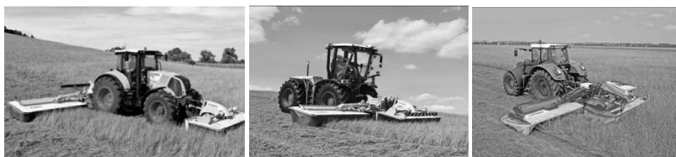
Sl. 2 Kombinacije kosilica: Claas DISCO 9300 C DUO s prednjom kosilicom na standardnom traktoru (lijevo) ili s prednje strane sistemskog kompaktnog traktora (u sredini) i Pöttinger NovaCat X8 sa sve tri kosilice na stražnjoj strani traktora koji se kreće unatrag (desno)
