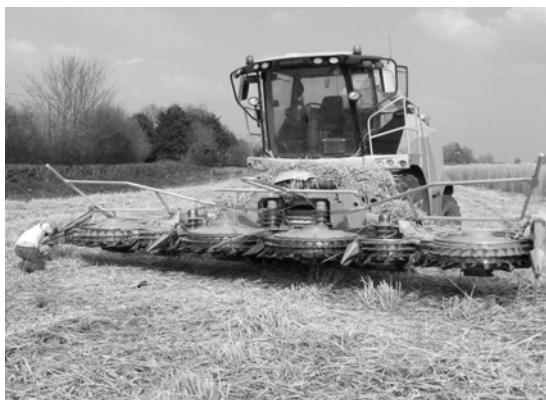
Slika 4 Univerzalni kombajni heder s rotirajućim nazubljenim valjcima ( www.blogspot.com )
