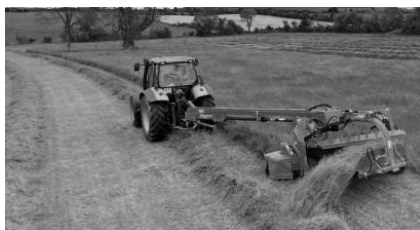
Sl. 1 Vučena kosilica Kverneland-Taarup 4340 s mogućnošću spajanja otkosa
