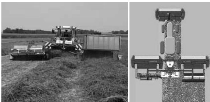
Sl. 4 Oblikovanje dva otkosa podizanjem i isključivanjem uređaja s beskonačnom trakom na desnoj kosilici, Pöttinger kombinacija kosilica
